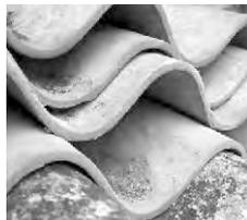
Asbesthaltige Eternitplatten dürfen seit 1993 nicht mehr genutzt werden, eine Entsorgung mit Bauschutt ist verboten
